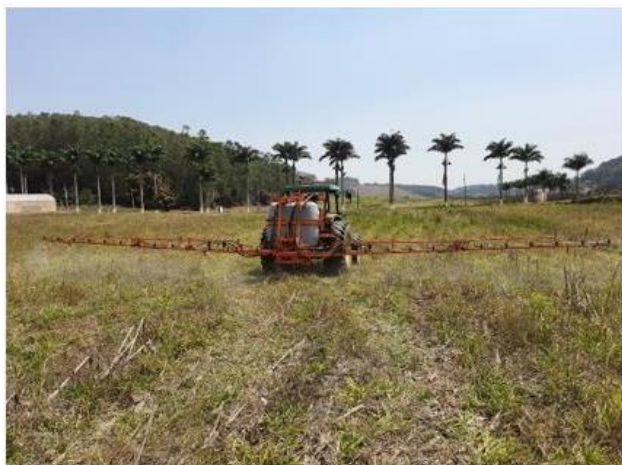
Figura 4.2. Pulverizadores de barra para acoplamento ao engate de três pontos do trator Foto: Francisco Cláudio Lopes de Freitas.
